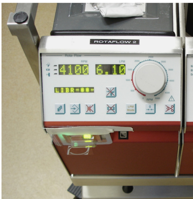
Figure 1 Circuit d'ECMO: en haut, la pompe centrifuge électrique qui génère un débit continu et l'oxygénateur à membrane; en bas le contrôleur, montrant ici que le débit généré par la pompe est à 6,1 L/Min pour 4100 t/min.
